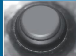
Tiefer Ziehring Materialablagerung in Winkel und Ziehkanal
